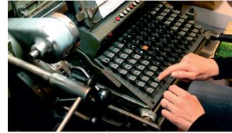
Tastatur der Zeilenguss-Setzmaschine
